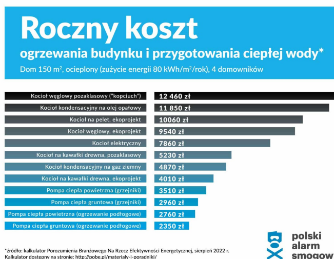
Rysunek 38 Porównanie kosztów ogrzewania budynku mieszkalnego
